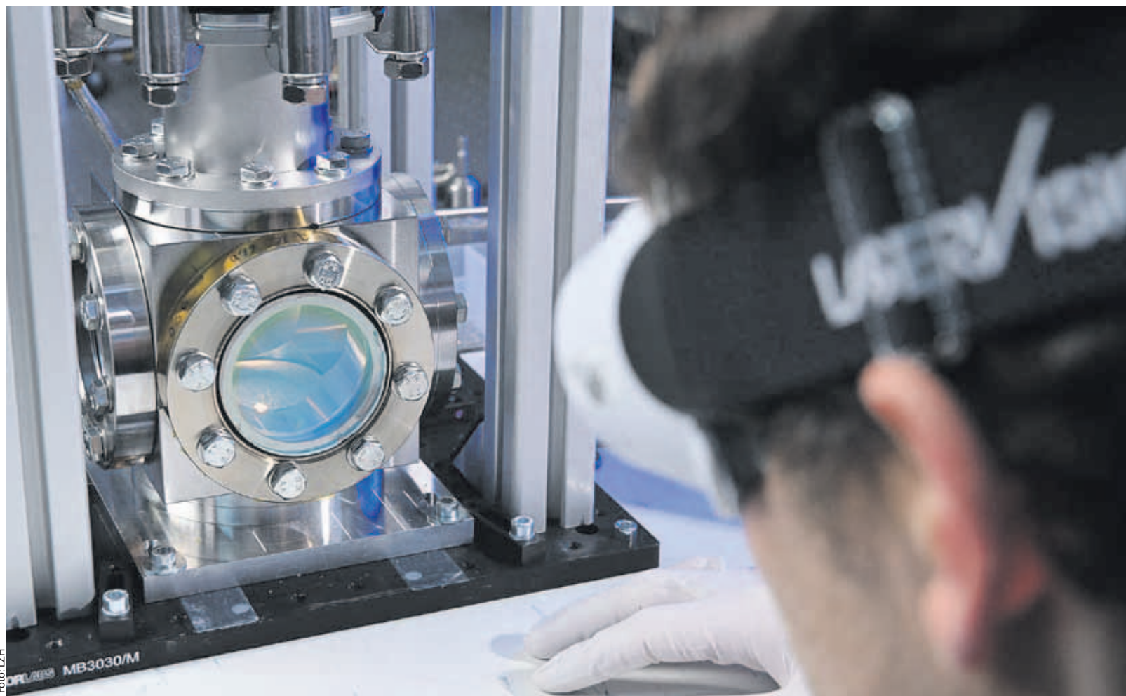
Erste Tests im Vakuum: Der eigens für das Projekt entwickelte „Moonrise“-Laser schmilzt erfolgreich Kugeln aus Mondstaub auf.
