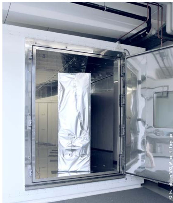
Prüfkammern von bis 48 m 3 Größe machen am Fraunhofer WKI die Untersuchung ganzer Wände möglich
