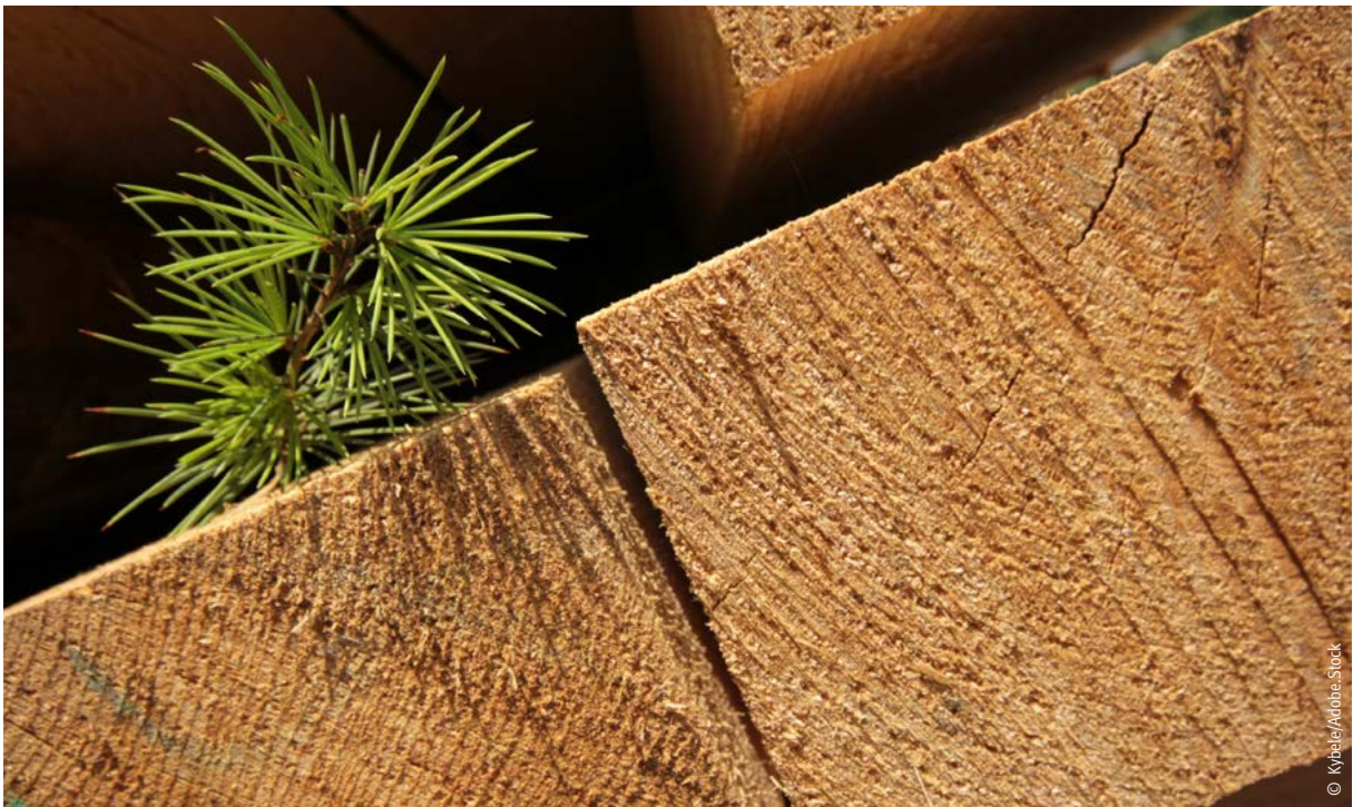
Holz weist als natürlicher Baustoff typische Emissionen wie Terpene, Aldehyde und Carbonsäuren auf
