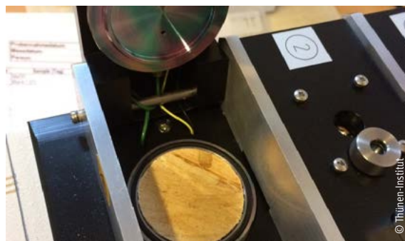
Anordnung einer OSB-Probe in einer Zelle der \mu -CTE
